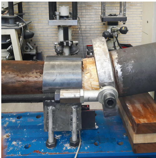
Figuur 3 – Rotatie van de verbinding tijdens de proef.
